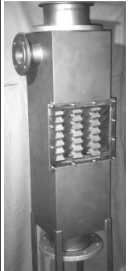
Abb. 5: Abscheider aus Edelstahl 1.4571 für 1.000 Nm 3 /h Gas.
